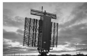
3D雷达,即通过机械扫描、电扫描的方式获取相关目标三维坐标的一种雷达。它对引导作战起着关键作用,所采用的平面阵列天线是其重要标志。
