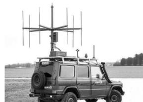
无源雷达,是一种不用发射机发射能量而靠接受受测物体或他源反射的微波能量探测目标的雷达。它有天线和灵敏度极高的信号接收装置。
