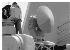
火控雷达,是指为武器系统提供数据参数并引导火力进行打击的雷达。它属于典型的精密跟踪雷达,配合探测雷达和火控系统使用。
